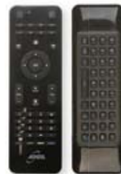
Buono Telecomando da un lato e tastiera sul lato opposto.
