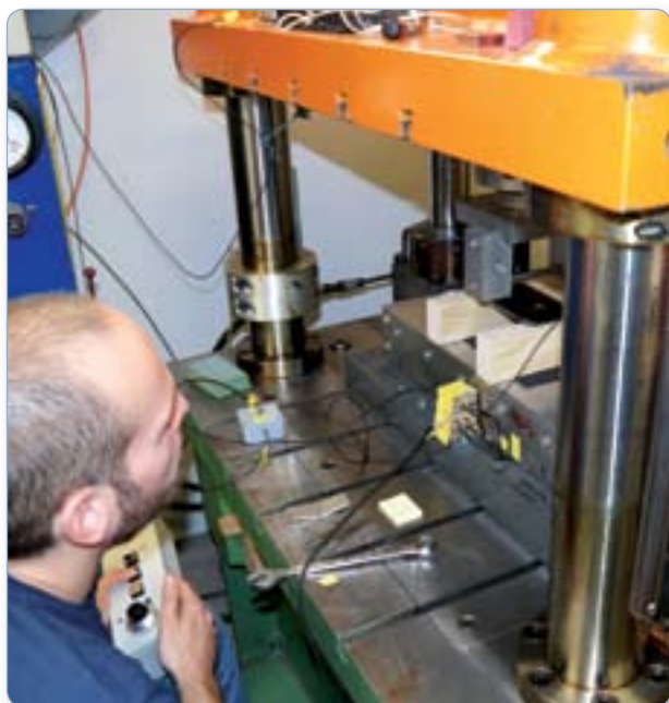
La prova di pressione a cui abbiamo sottoposto i sette telefoni: ognuno di essi è stato collocato su due basi, in modo che fosse appoggiato con il 15% della sua superficie, e il peso è applicato al centro. Con la stessa prova, una comune matita si spezza con circa 10 kg.
