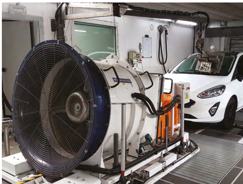
In laboratorio l'auto viaggia sul banco a rulli. Mentre vengono misurati i consumi e le emissioni, un apparecchio raffredda il radiatore simulando il flusso d'aria esterna.
